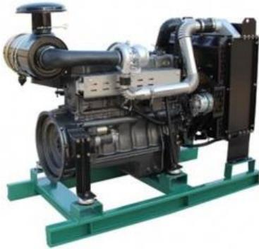
Промышленный дизельный двигатель серии RICARDO R6105IAZLD - 6-ти цилиндровый, рядный, 4-х тактный, с механическим регулятором оборотов, турбонаддув. Мощность: 132кВт(165кВа)/1500об/мин
